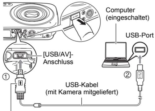
Kontrollieren Sie, dass der Stecker des USB-Kabels mit dem Zeichen ↑ auf die Objektivseite ausgerichtet ist, und schließen Sie das Kabel an die Kamera an.
