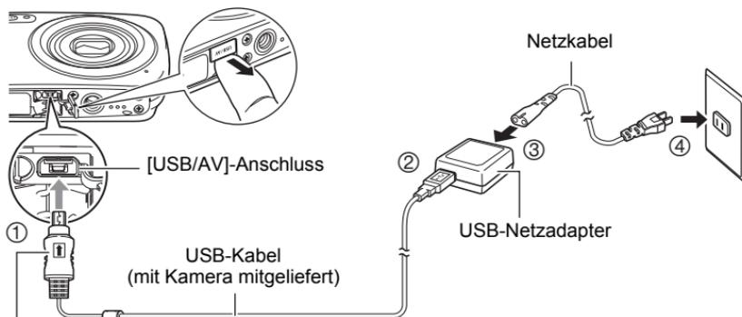
Kontrollieren Sie, dass der Stecker des USB-Kabels mit dem Zeichen
