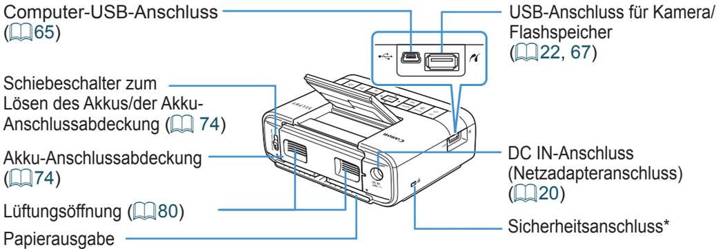
\* An diesem Anschluss können Diebstahlsicherungen, z. B. ein Kensington-Schloss, angebracht werden.
